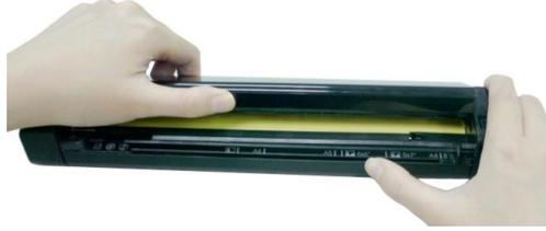
2. قم برفق بمسح الزجاج وأسطوانات التغذية على الماسح الضوئي وغطاء CIS باستخدام قطعة القماش الخاصة بالتنظيف (مزودة).
